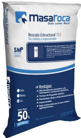
Microconcreto estructural de muy altas resistencias mecánicas ( $740 \text{ Kg/cm}^2$ ), sin contracciones e impermeable, formulado para la reparación de todo tipo de elementos estructurales de concreto, recubrimientos a base de cemento portland, muros de concreto, block, ladrillo, etc. Su rápido proceso de fraguado permite la liberación de la obra en pocas horas ( $250 \text{ Kg/cm}^2$  en 3 horas).
